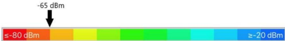
Il est important de noter qu'un signal minimum de -65 dBm est impératif pour avoir une connexion correcte sans perturbations.
